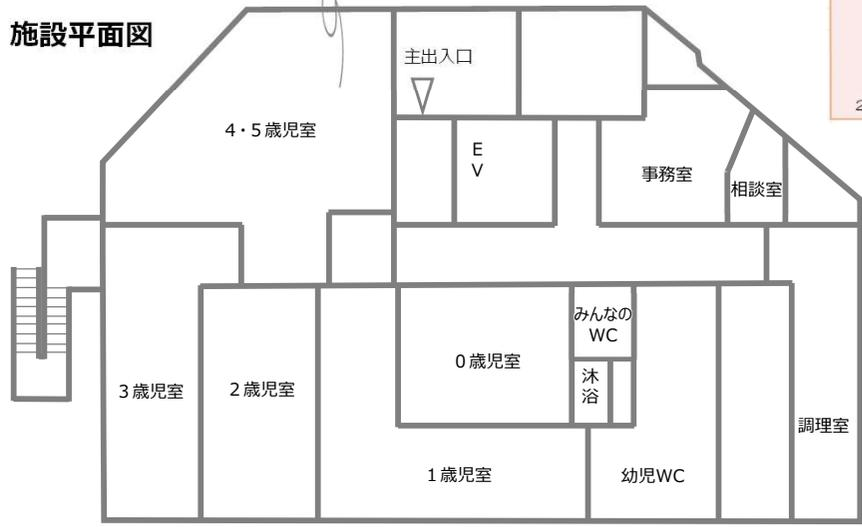
【構造】 鉄骨造(耐火建築物) 【面積】 延床面積380.98㎡
